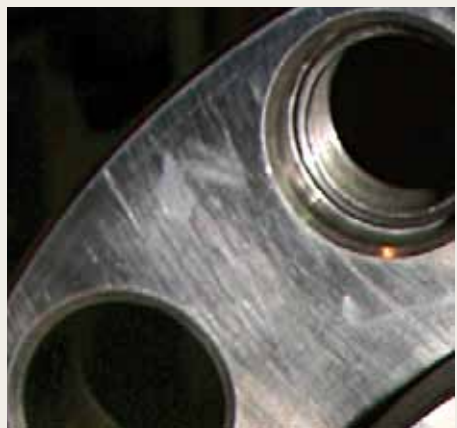
A főelzáró tolózár osztósíkjának ellenőrzése
